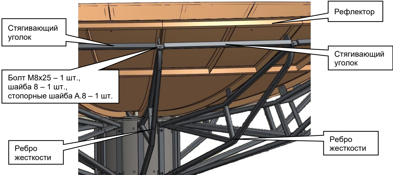
Рисунок 21 – Крепление стягивающих уголков к рефлектору
